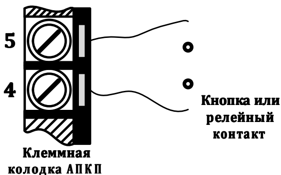
Рисунок 7. Схема подключения цепи внешнего сброса
