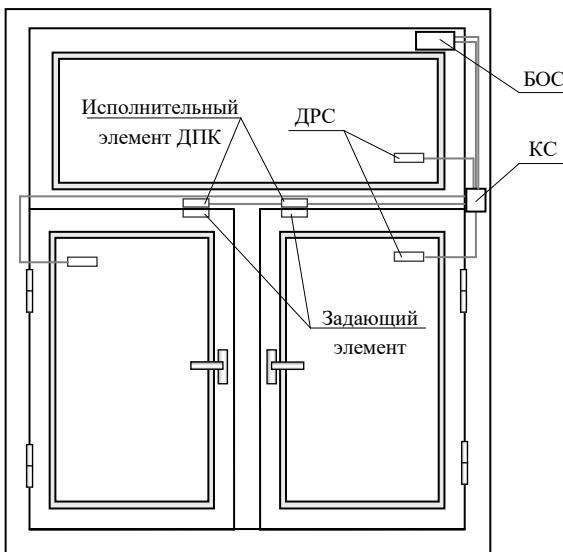
Рис. 1 – Вариант размещения извещателя охраны оконного проема
