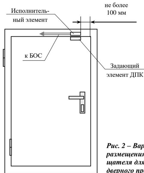
Рис. 2 – Вариант размещения извещателя для охраны дверного проема
