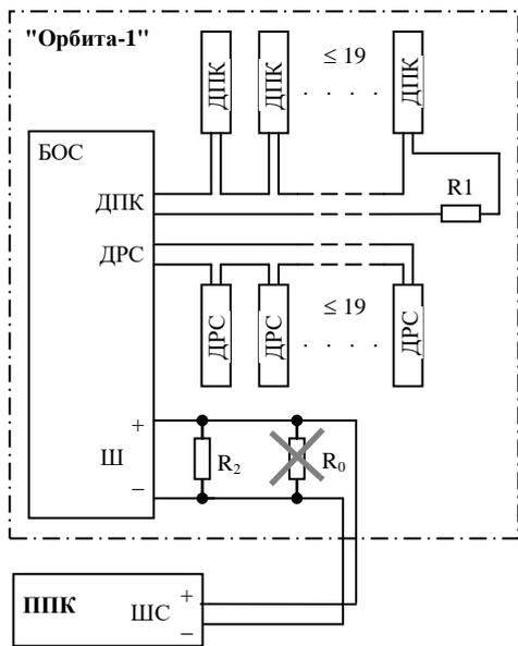
Рис. 3 – Схема подключения извещателя "Орбита-1"
