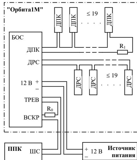
Рис. 4 – Схема подключения извещателя "Орбита-1М" с объединенной передачей извещений о тревоге и вскрытии корпуса (по общему ШС)
