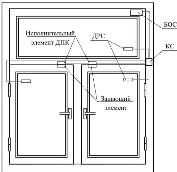
Рис. 1 – Вариант размещения извещателя для охраны оконного проема
