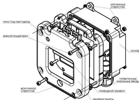
Рис. 1 Элементы конструкции устройства
